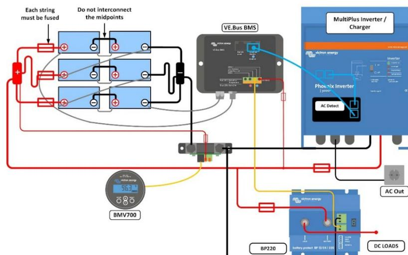
Unsere LFP-Batterien verfügen über eine integrierte Zellenausgleichs- und über eine Zellenüberwachungsfunktion. Die Kabel der Zellenausgleichs-/Überwachungsfunktion lassen sich miteinander verketteten und müssen an ein Batterie-Management-System (BMS) angeschlossen werden.
